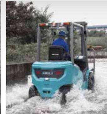
Nach 10 Minuten Fahrt durch ein Wasserbad mit einer Tiefe von 200 mm kein Fehler!
