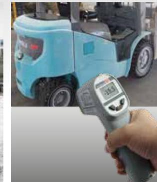
Das gesamte Fahrzeug wurde 6h in kalter Umgebung bedient bei -20°C. Außerdem wurden Tests zum Parken in der Kälte durchgeführt (12h). In beiden Szenarien konnte ohne Probleme weitergearbeitet werden
